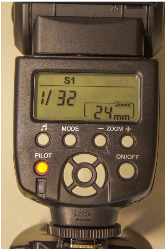
Slave-Blitz mit 1/32 Leistung und Weitwinkleinstellung
